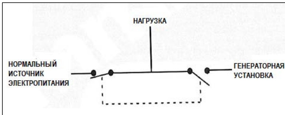
Рис. 14 Функция типового устройства переключения нагрузки
